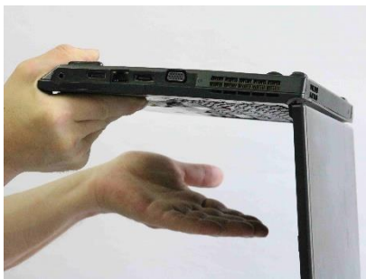
Entfernung von Schmutz aus der Tastatur durch Umdrehen und mit Pinsel
